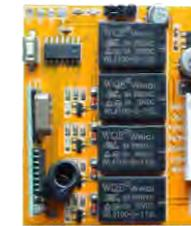
WSM-2/WSM-4无线转有线模块。用于无线探测器配智能楼宇等设备。
